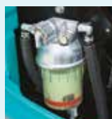
Préfiltre avec décanteur d'eau intégré
