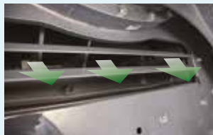
Chicanes d'insonorisation de sortie des flux d'air
