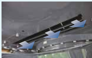
Système de ralentisseur des flux d'évacuation (anti-poussière).
