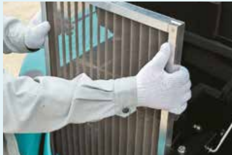
Son maillage ondulé permet d'éviter le colmatage du filtre iNDR.
