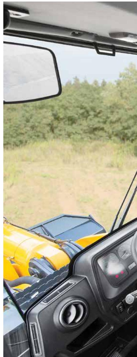
La cabine protège l'opérateur du bruit et des vibrations et est bien ventilée. Le contrôle avancé de la température, permet un réglage précis en toutes saisons, dans une cabine hermétique et pressurisée afin d'empêcher l'intrusion de poussière.
