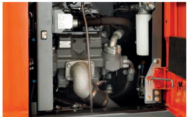
Le système hydraulique HIOS V (ZX150W-7 et ZX155W-7) une économie de carburant jusqu'à 5 %.
