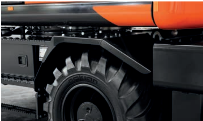
Les ailes sur le châssis inférieur protègent la structure et les feux supérieurs contre la saleté, pour garder la machine propre.
